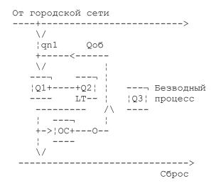
Принципиальная схема совершенствования водоснабжения промышленных предприятий по упорядочению водоиспользования на технические цели: а - по прямоточной системе; б - с повторным использованием воды; в - применение оборотного водоснабжения; г - повторно (с очисткой воды) - оборотное водоснабжение; д - повторное (с очисткой воды) водоснабжение - применение безводного процесса
